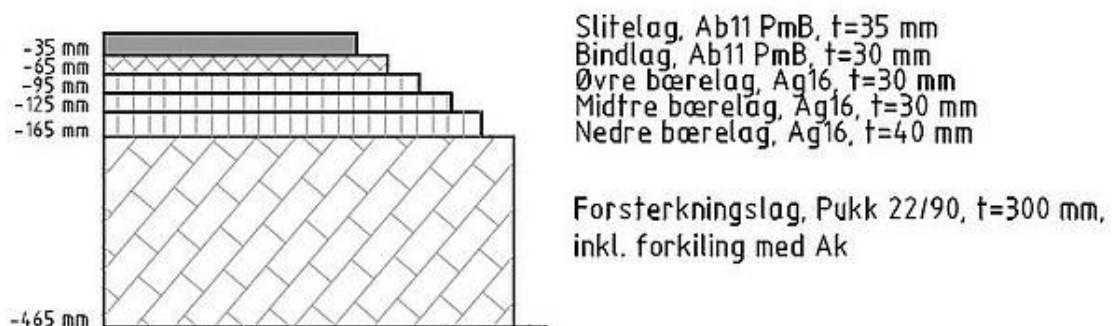
Figur 7. Antatt vegoppbygging. Kilde: Wikimedia Commons (File: Eksempel på oppbygging av en norsk fylkesveg .jpg).
