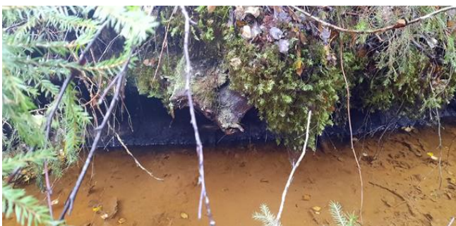
Figur 5 Nordlig side av bekkeløp vist i Figur 6. Noe utvasking av sidene, men ingen tegn til leire. Løsmassene ser ut til å i hovedsak være brunjord og torvmasser.
