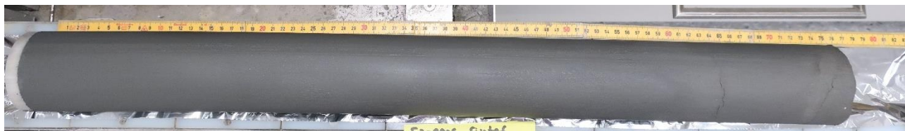
Dybde 8,0-8,8 m (74 mm sylindrerprøve)
