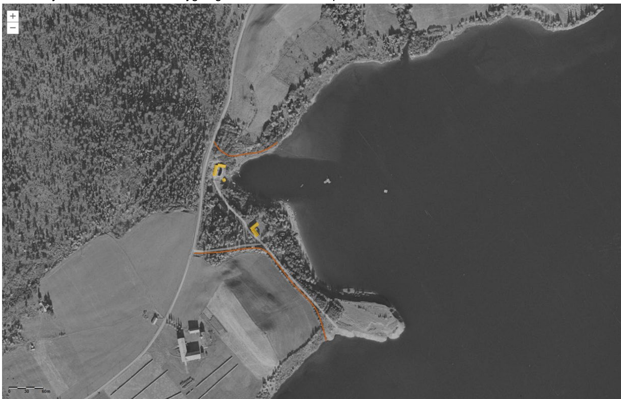
Figur 7. Flyfoto fra 1952. Antatt opprinnelig inngrepsgrense markert med orange streker. Kilde: www.norgebilder.no
