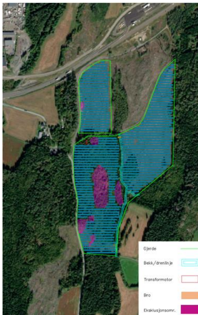
Figur 3: Oversikt over planområdet. Det grønne omrisset er gjerdet rundt kraftverket, blå felter er solcellemoduler. De tre transformatorene er markert med røde rektangler. Lilla markeringer er områder som ikke er egnet til å montere solceller. De turkise strekene midt i figuren er en bekk/grøft, som krysses av en bro (oransje linje) for å sikre trygg ferdsel.
