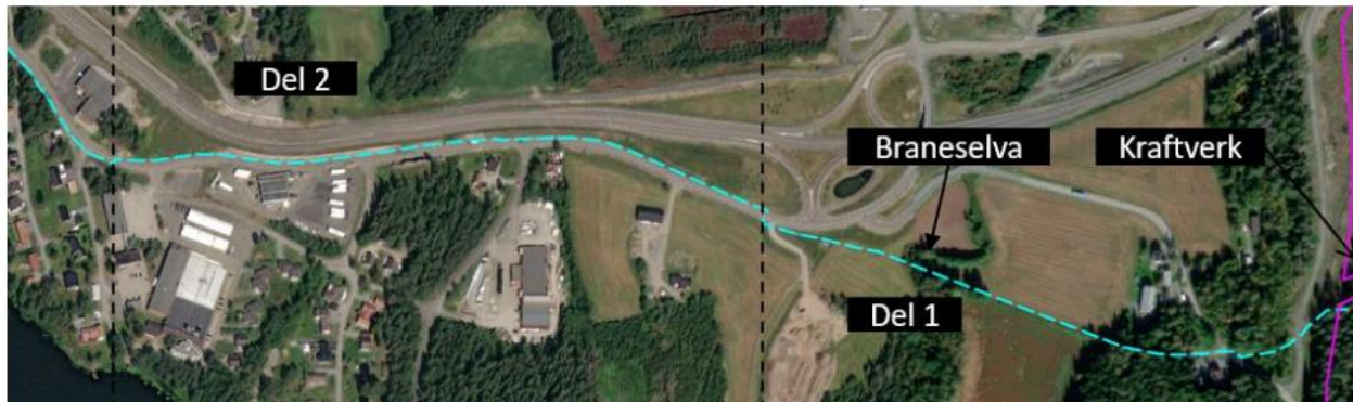
Figur 11: Illustrasjon av den østlige delen av kabeltraséen fra solkraftverket. Kabeltraséen er presentert som turkis stiplet strek. Grensen for planområdet til solkraftverket er vist med lilla strek helt i øst.
