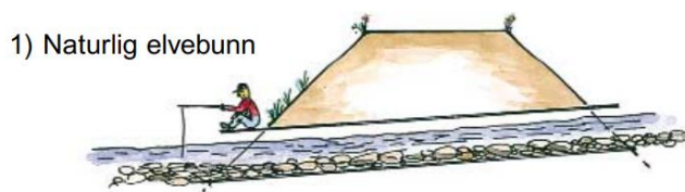
Figur 4-1. Ønsket utforming av fiskepassasjen gjennom bunnlastsperren (se fig. 5.1 i «Slipp fisken fram!» [11]).
