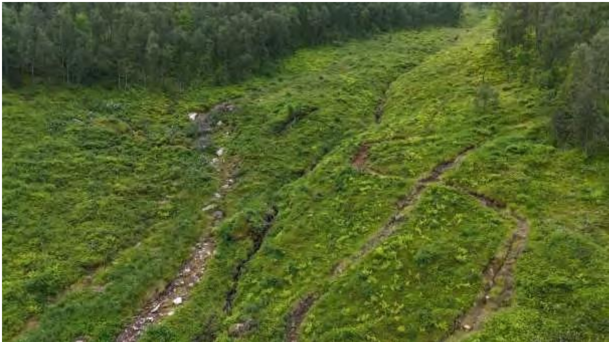
Figur 44 viser bekkeløp i nedre del av påvirkningsområdet. Området er bratt nok og har tilstrekkelig løsmasser som kan lede til utløsning av flomskred.
