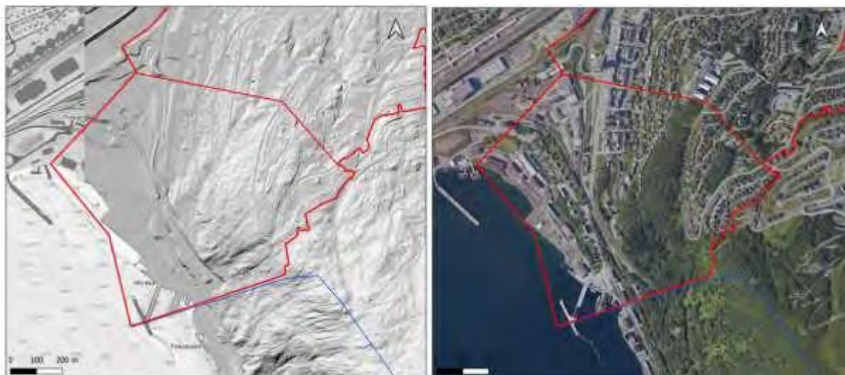
Figur 33 viser skyggerelieff og flyfoto 2017 av område 1. Legg merke til forsenkningene i terrenget helt sør i kartleggingsområdet på skyggerelieffkartet.
