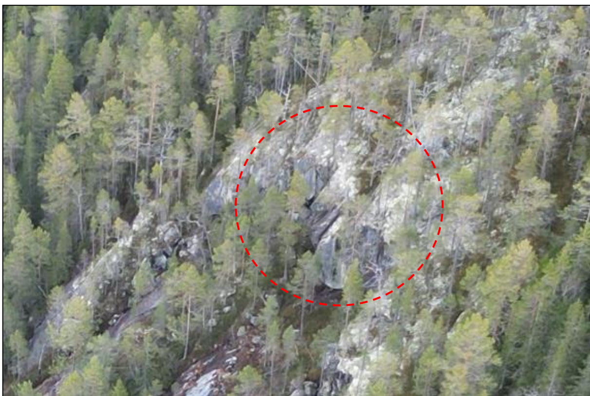
Figur 14: Utsnitt fra dronebilde tatt mot øst over den østlige delen av kartleggingsområdet. Bildet viser at det stedvis er potensielt ganske store sprekkeavgrensede bergblokker (rødt).
