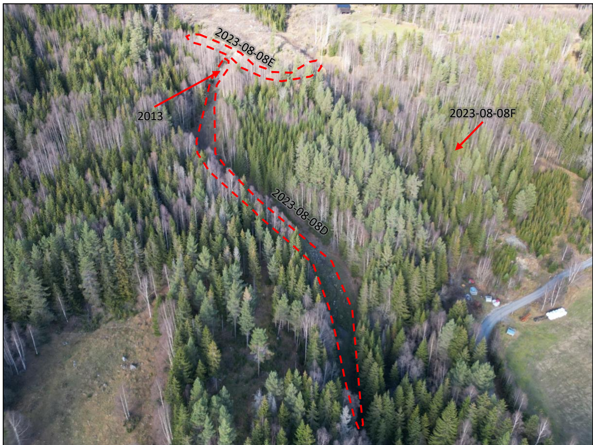
Figur 19: Oversiktsbilde fra drone (sett mot nord) som grovt antyder plassering og utbredelse av skredhendelsene 2023-08-08D-F og 2013.
