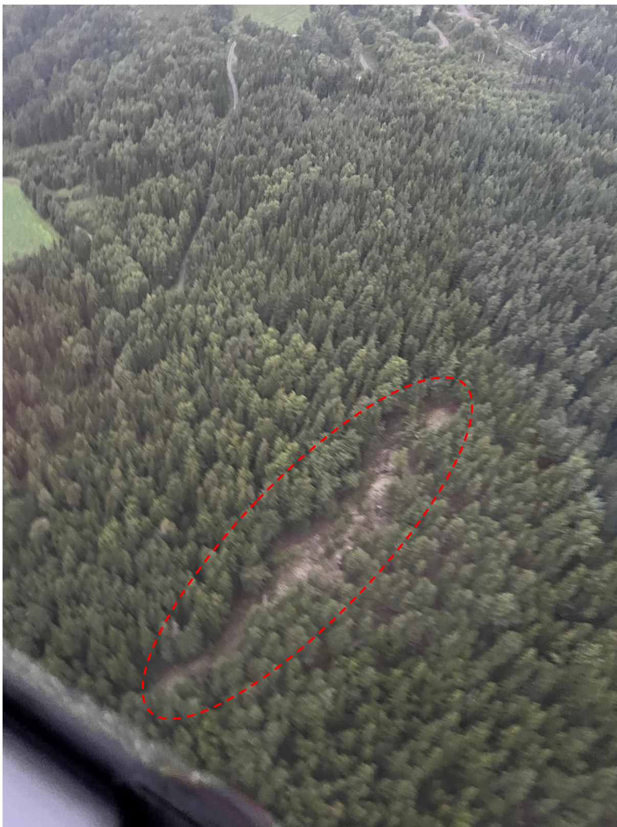
Figur 25: Over den østlige delen av område 1 er det observert det som ble antatt å være et skredløp på helikopterbefaring under Hans. Ved nærmere undersøkelser viser det seg at dette har vært et parti fritt for vegetasjon i lang tid, og ikke representerer et nylig skred.
