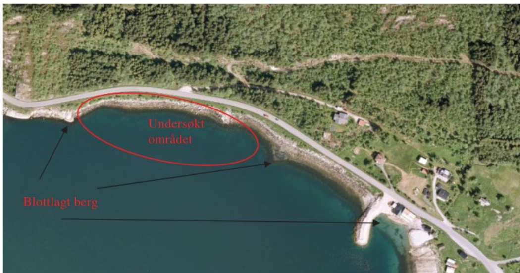
Figur 4-4: Bilde kopiert fra rapport 711353-RIG-RAP-001 [6]. Viser blottlagt berg på strekningen fra og med veiprofil 2050 til og med 2500.
