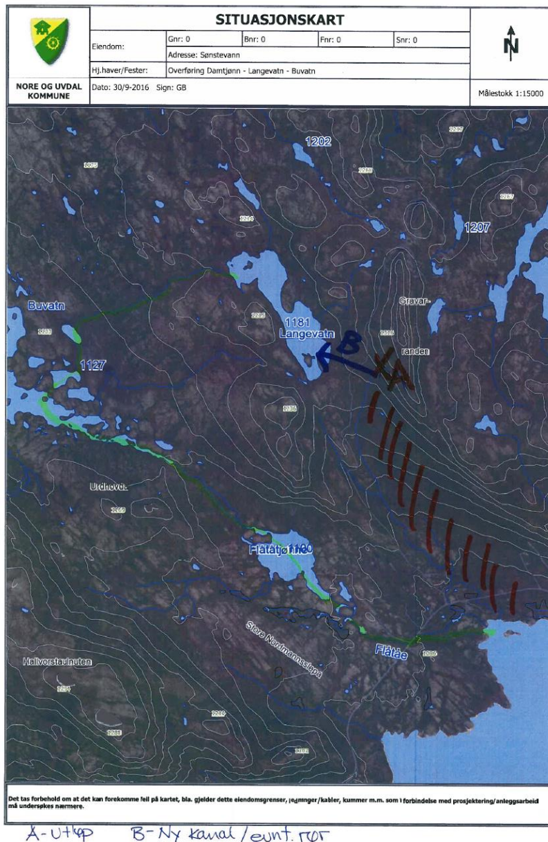
Figur 16. Forslag til flomtiltak for overføring av vann til Sønstevann. Det overført vannet renner i dag ned bekken (Skravert område).
