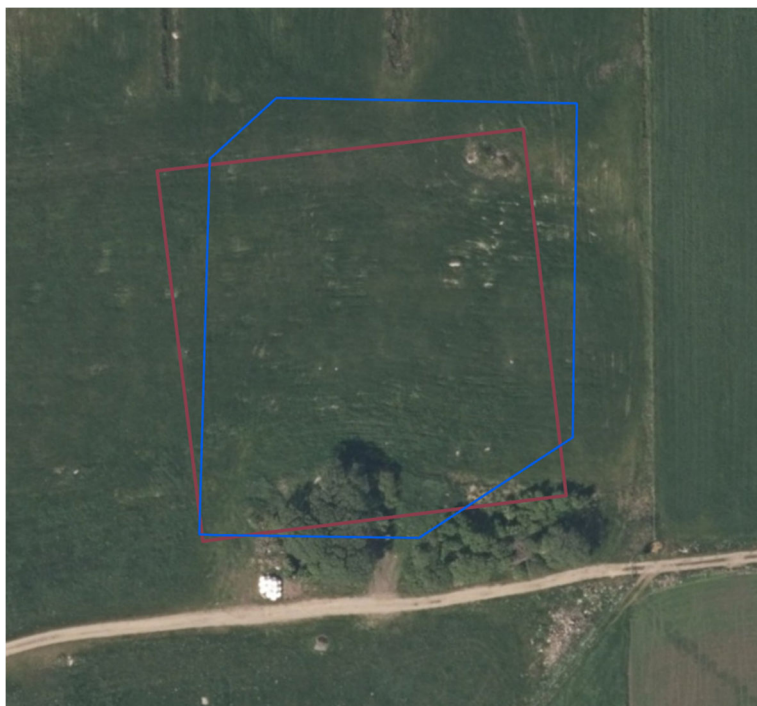
Figur 7-2 Stasjonsgjerde opprinnelige avgrensning (rød strek), mens blå strek avgrensning med 132/22 kV transformering på Hellemyra.
