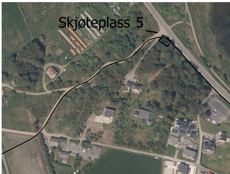
Figur 6-15 Kabelanlegg langs en avstikker fra Søndre vei. Det er mulighet til omkjøring på vei rett øst for veien.
