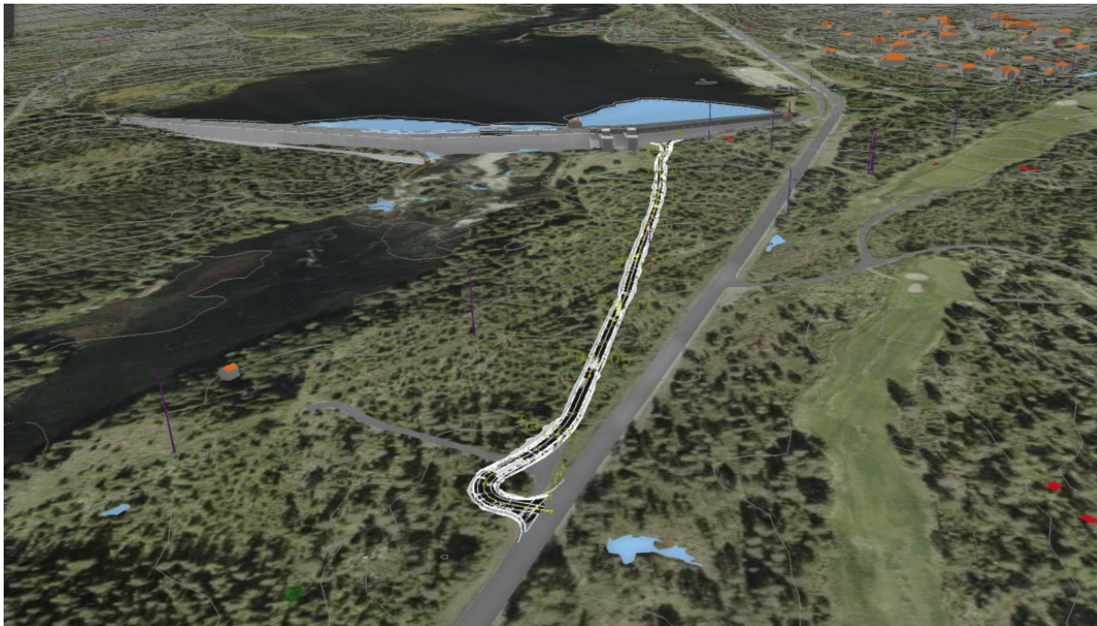
Figur 8: Illustrasjon av utbedring av avkjørsel og vei fra Hemsedalsvegen til dam Eikrebekken.
