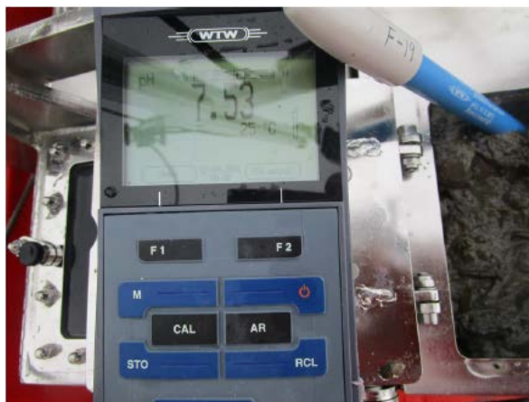
Figur 2-4. Måling av pH i sedimentet (Foto: DNV GL).
