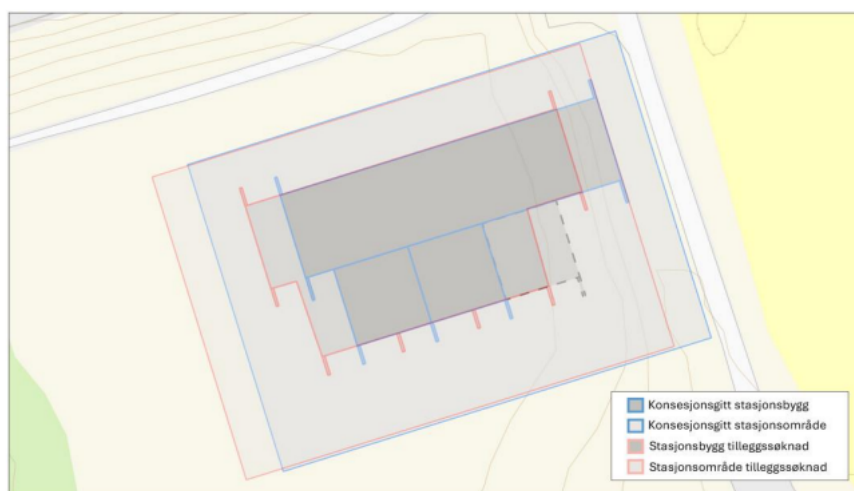
Figur 1: Illustrasjon av hvordan transformatorstasjonen og stasjonsområdet forflyttes omtrent 5 meter mot sørvest. Blått omriss viser den konsesjonsgitte plasseringen av 14. august 2024 og rødt omriss viser omsøkt plassering. Kilde: Lnetts konsesjonssøknad av 4. august 2025.
