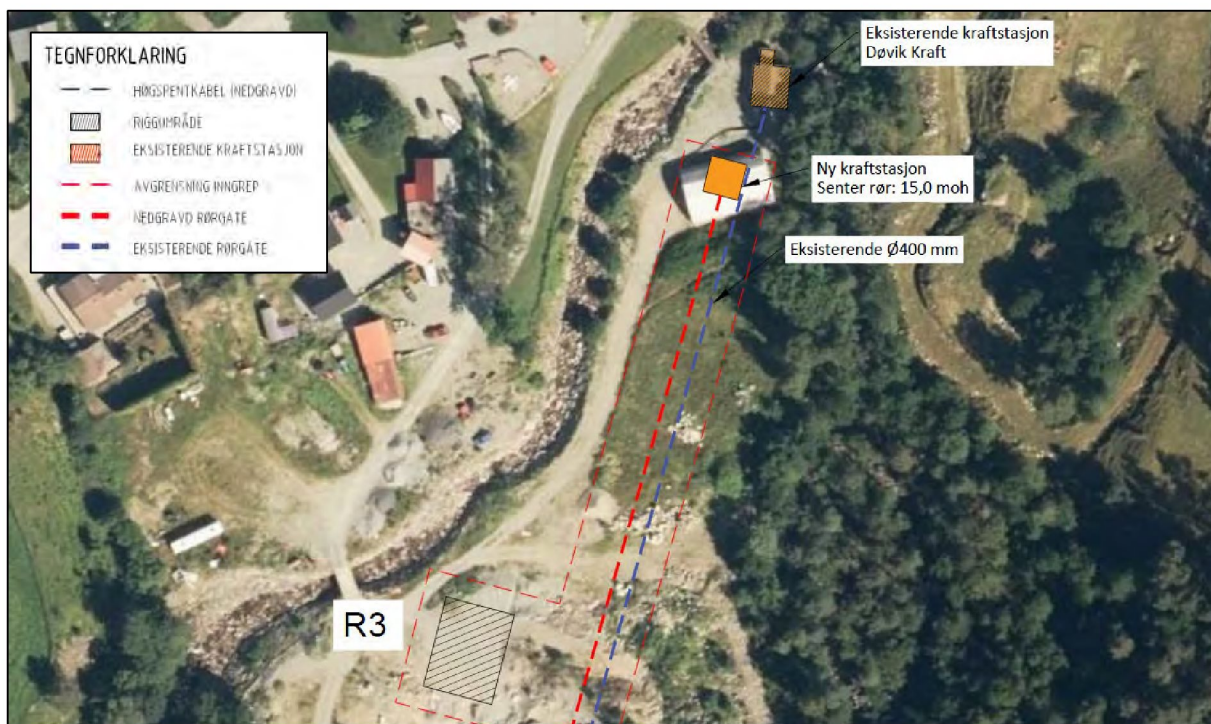
Figur 4. Posisjonering av planlagt kraftstasjon i Døvik. Ny kraftstasjon ønskes plassert like ved eksisterende kraftstasjon som skal avvikles. Oversiktsplan utarbeidet av Eide Konsult AS.
