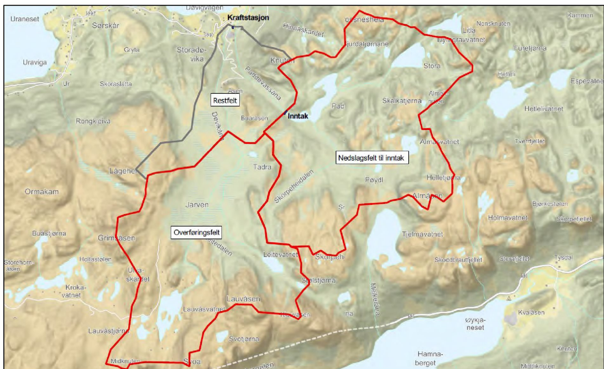
Figur 6. Oversikt over nedbørfelt til planlagt inntak ( 4,8 \text{ km}^2 ) og overføringsfelt ( 4,3 \text{ km}^2 ), samt restfelt ned mot planlagt kraftstasjon ( 1,12 \text{ km}^2 ). Utnyttet nedbørfelt er på 9,1 \text{ km}^2 . Verdier basert på Skjema for dokumentasjon av hydrologiske forhold for små kraftverk utarbeidet av Sweco.
