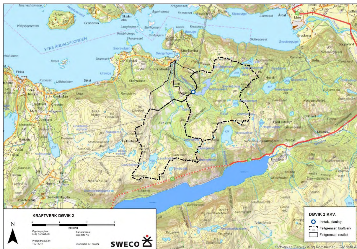
Figur 1. Kart som viser nedbørfeltet til kraftverkets inntakspunkt og restfelt. Kraftverket og inntakspunkt skal og tegnes inn.
