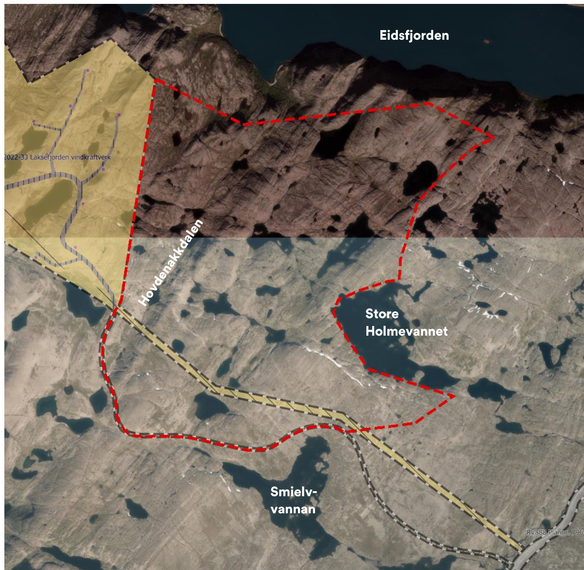
Figur 3. Ortofoto med planavgrensning i rødt. Gjeldende reguleringsplaner vises gjennomskiktig med plankartfarger. Gult areal er regulert til vindkraftområde, herunder høyspenttrase til fv. 888. Nærmest Smielvvannan går trase for adkomstvei mellom fv. 888 og vindkraftområdet. Kilde: Norge i Bilder, Lebesby kommune
