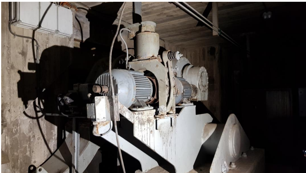
Kjedespill – flomluker. Foto DNV
