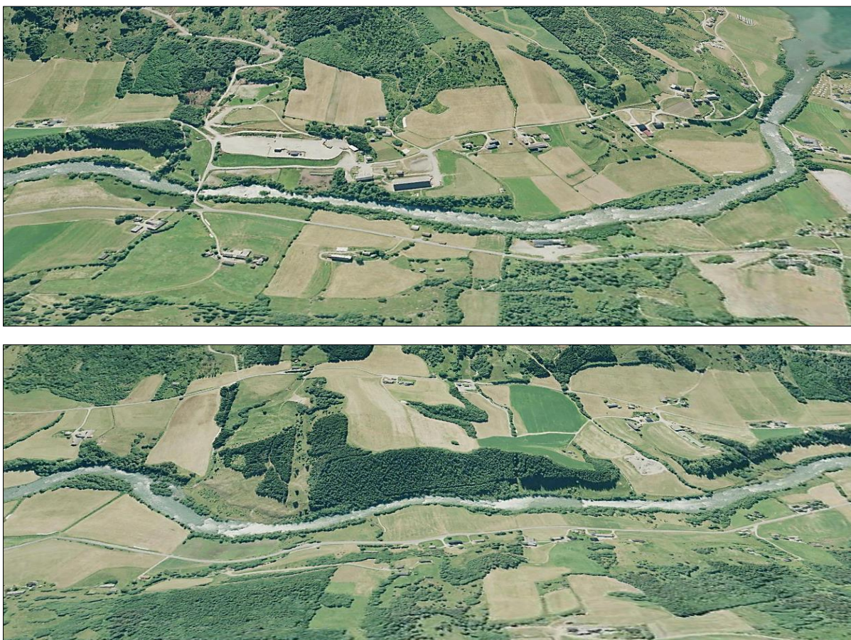
Figur 5-2: Det er ingen erosjon i tilgrensende løsmasser langs Storelva i dag (elva er forbygd langs store deler av den aktuelle elvestrekningen).
