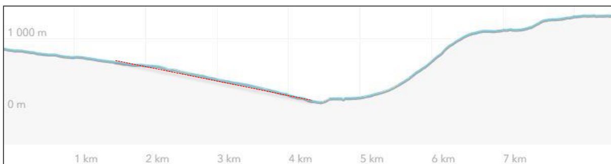
Figur 6-1: Tverrsnitt over dalføret fra nord til sør. Fra det flattere terrenget i nord vil foranliggende terreng hindre eksponering fra tiltakene, som illustrert med rød linje i profilet.
