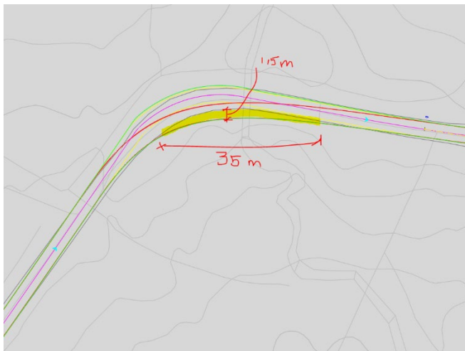
Figur 5-4 Oppgradering av tilkomstvei i svingen rett vest for transformatorstasjonen.
