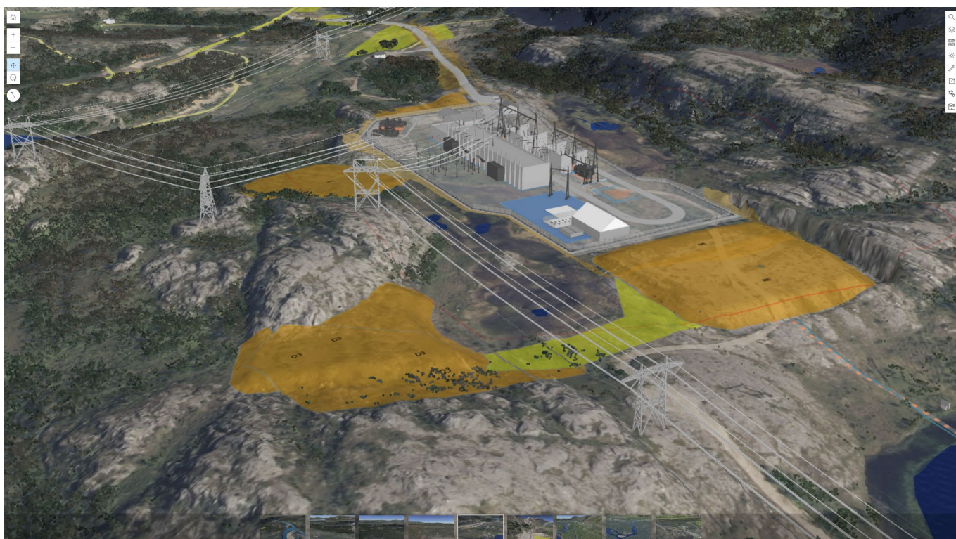
Figur 6: 3D skisse av stasjonen som viser areal for masseuttak til høyre i bildet (karthenvisning R6) og område for permanent masselager til venstre i bildet (D3). Figuren viser ikke innføring av eksisterende ledning
