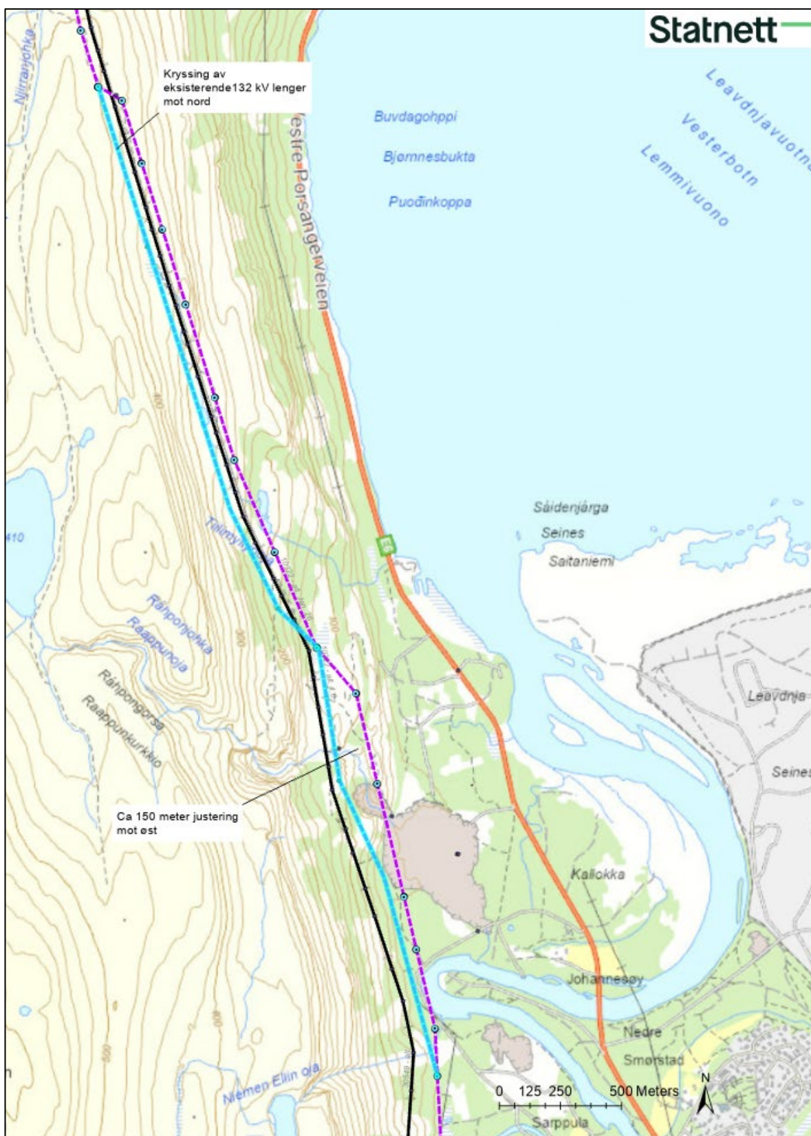
Figur 5: Kart som viser trasejustering ved Rahppa. Turkis strek viser konsesjonsgitt trase og lilla trase er den som nå er planlagt. Se også visualisering av traseén i Figur 4.
