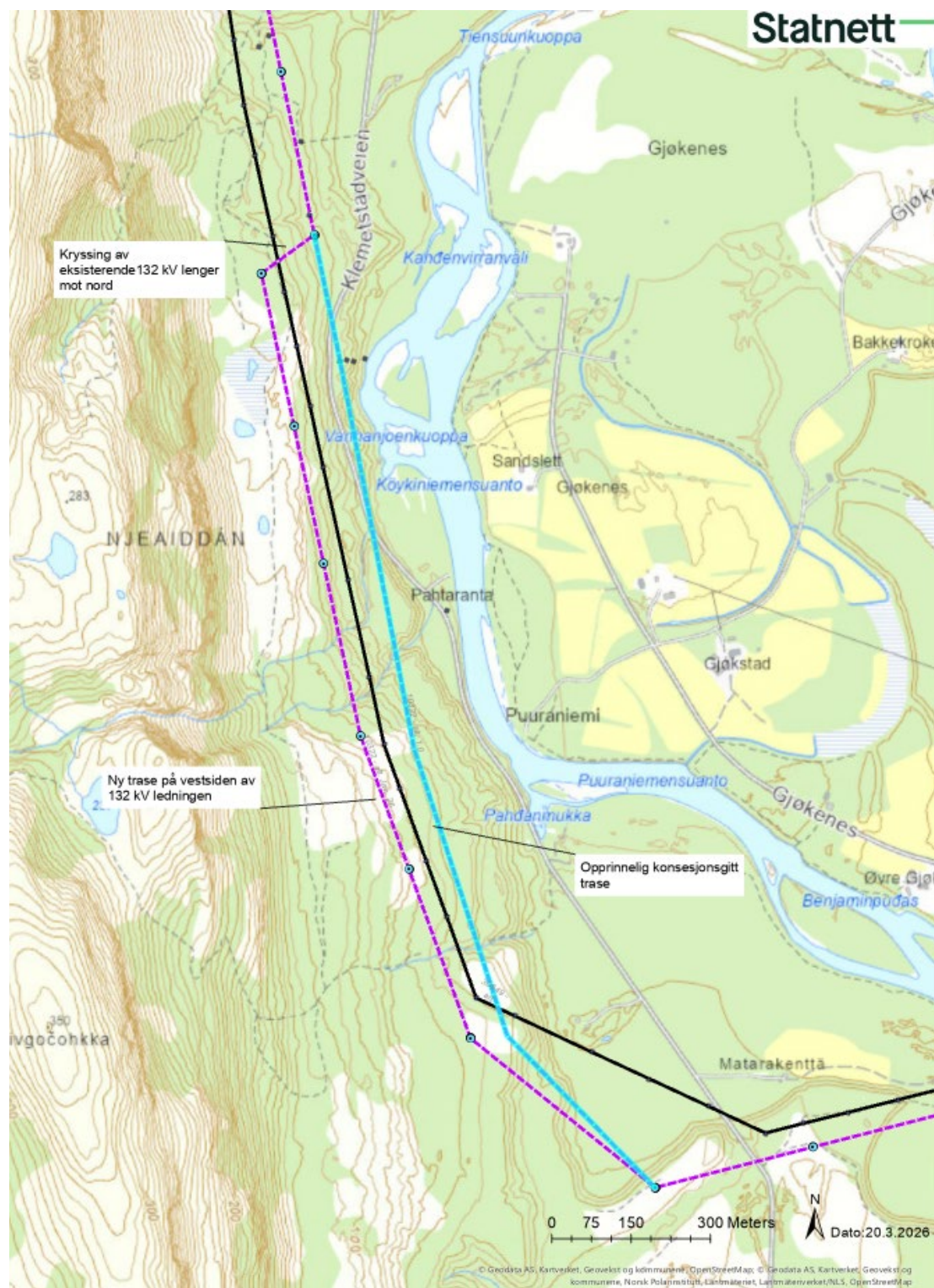
Figur 2: Kart over området Gjøkenes/Ekornbakken som viser opprinnelig konsesjonsgitt trasé med turkis og planlagt trase med lilla farge.
