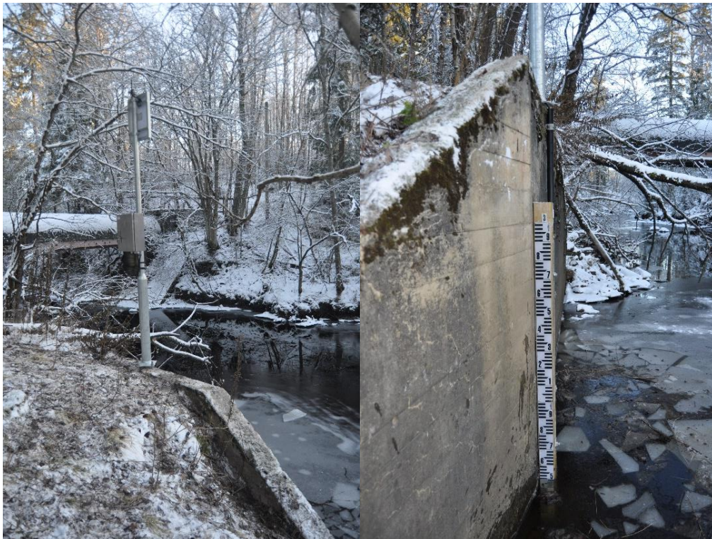
Figur 8. Eksempel på målestasjon for minstevannsregistrering med vannstandsskala (Heggelielva).
