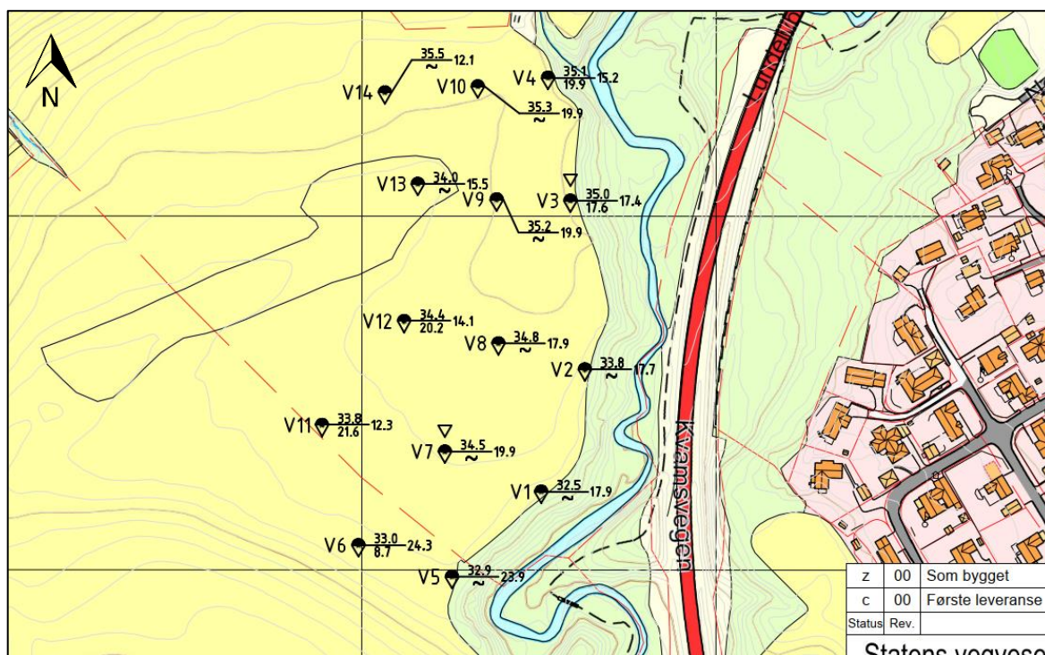
Figur 60 Utklipp av borplan RR7-OP-V som viser plassering av sonderingene i serie V.
