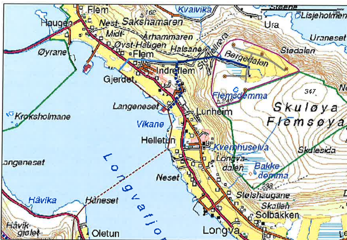
Figur 10 Omsøkt og vurdert kraftledningstrase fra Flemsfjellet vindpark til eksisterende 22 kV-nett. Mørk blå strek er omsøkt løsning, lys blå vurdert alternativ.
