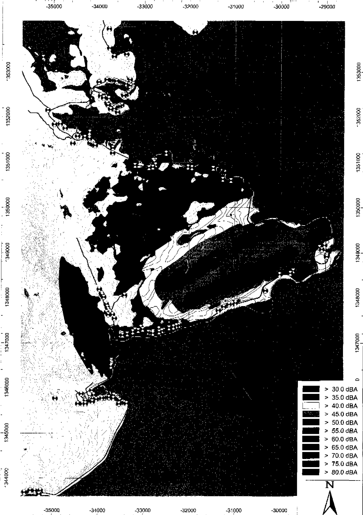
Figur 8: Alternativ 1: 20 stk 3 MW møller. Ekvivalent lydnivå fra vindmøllene. Lydnivået er beregnet med vind fra sørøst (150 grader). 🏠 = bygning med ekvivalent støynivå over 40 dBA.
