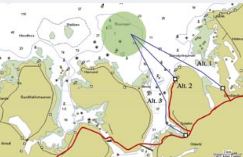
Mulige tilknytningstraséer til eksisterende nett. Blå linje – sjøkabel, rød linje – luftspenn.
