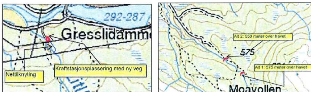
Figur 2. Forenkla og førebels utbyggingsplan for kraftverk i nedre del av Litlhena, Tydal kommune. Det ligg føre to alternative lokaliseringar av inntaksområdet, høvesvis oppstrøms og nedstrøms lita bro over Litlhena nordaust for Moavollen (skisser frå Sunnfjord Energi AS, datert 13. juli 2006).
