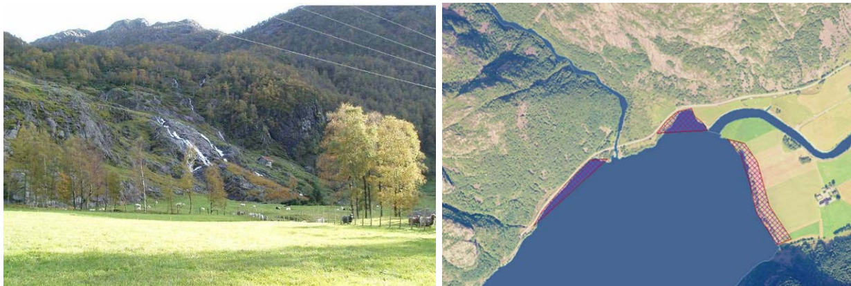
Figur 6.5. Til venstre: foss fra Stemmetjørn ved Gyagårdene (foto: T.Simensen, Sweco), til høyre: lokalisering av deponier ved Gya. Masser fra utbygging av Gya kraftverk vil bli deponert sør for Gyaåna, og masser fra Mjelkefossen kraftverk på nord- og vestsiden av Gyavatnet.
