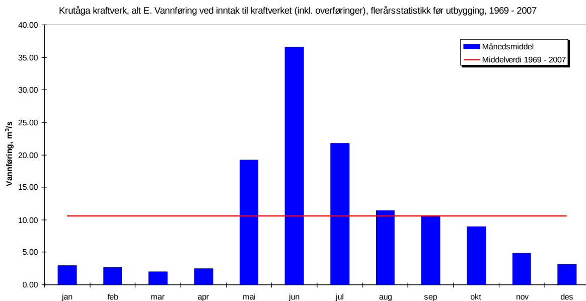
Figur 7-4: Variasjon av vannføring i Krutåga over året, fremstilt ved hjelp av månedsmiddelverdier.
