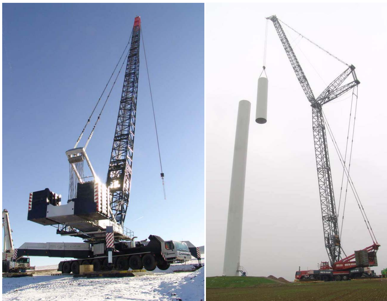
Figur 8 Bildene viser aktuelle krantyper, til venstre er LG 1750 til høyre LGD 1550. (kilde: Huma-krane.de.)
