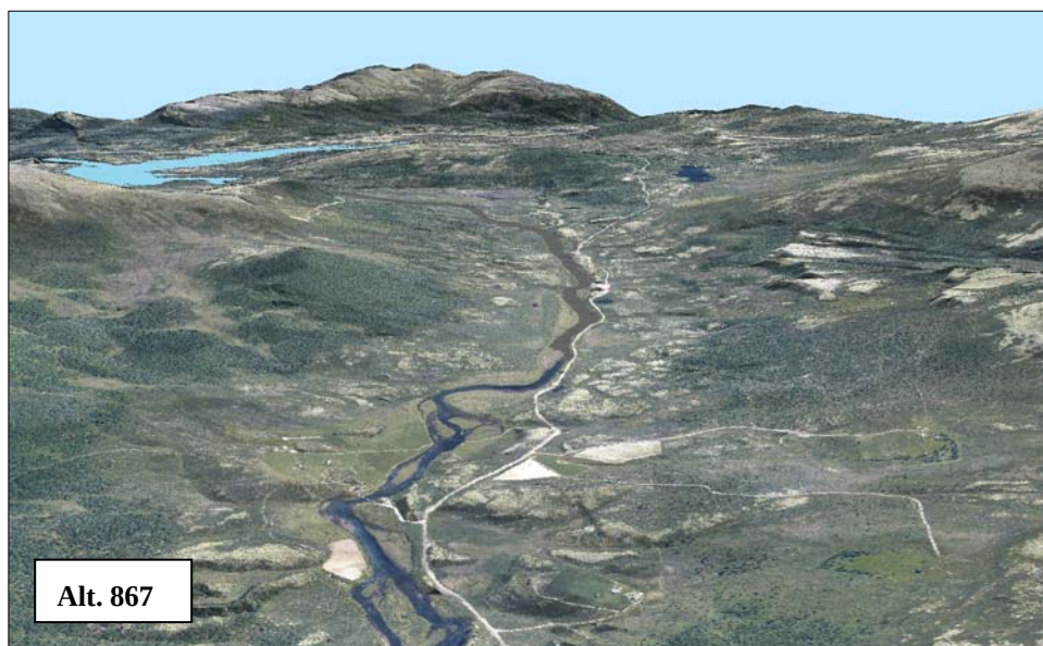
Figur 3.2 3D-bilder av magasinområdet sett fra vest ved ulike alternative reguleringshøyder. Vannstand i magasinet er 1,5 m under HRV (sommer LRV) på alle bildene. Brun sone angir arealer mellom HRV og sommer LRV
