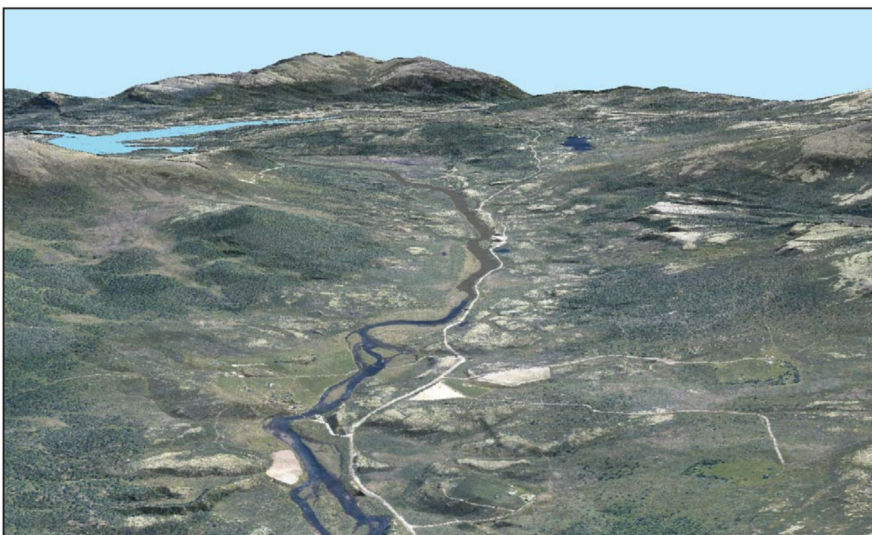
3D bilde fra Kjølhaug- og Randmelsætra ved HRV 867. Blå flate viser sommer LRV 865,50. Grått parti viser erosjonssone (uten avbøtende tiltak) mellom HRV og sommer LRV.
