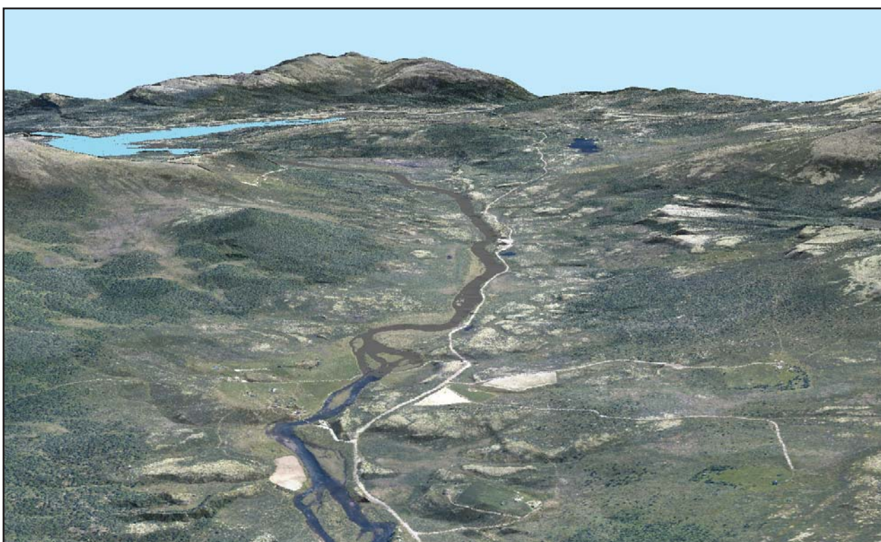
3D bilde fra Kjølhaug- og Randmelsætra ved HRV 868. Blå flate viser sommer LRV 866,50. Grått parti viser erosjonssone (uten avbøtende tiltak) mellom HRV og sommer LRV.
