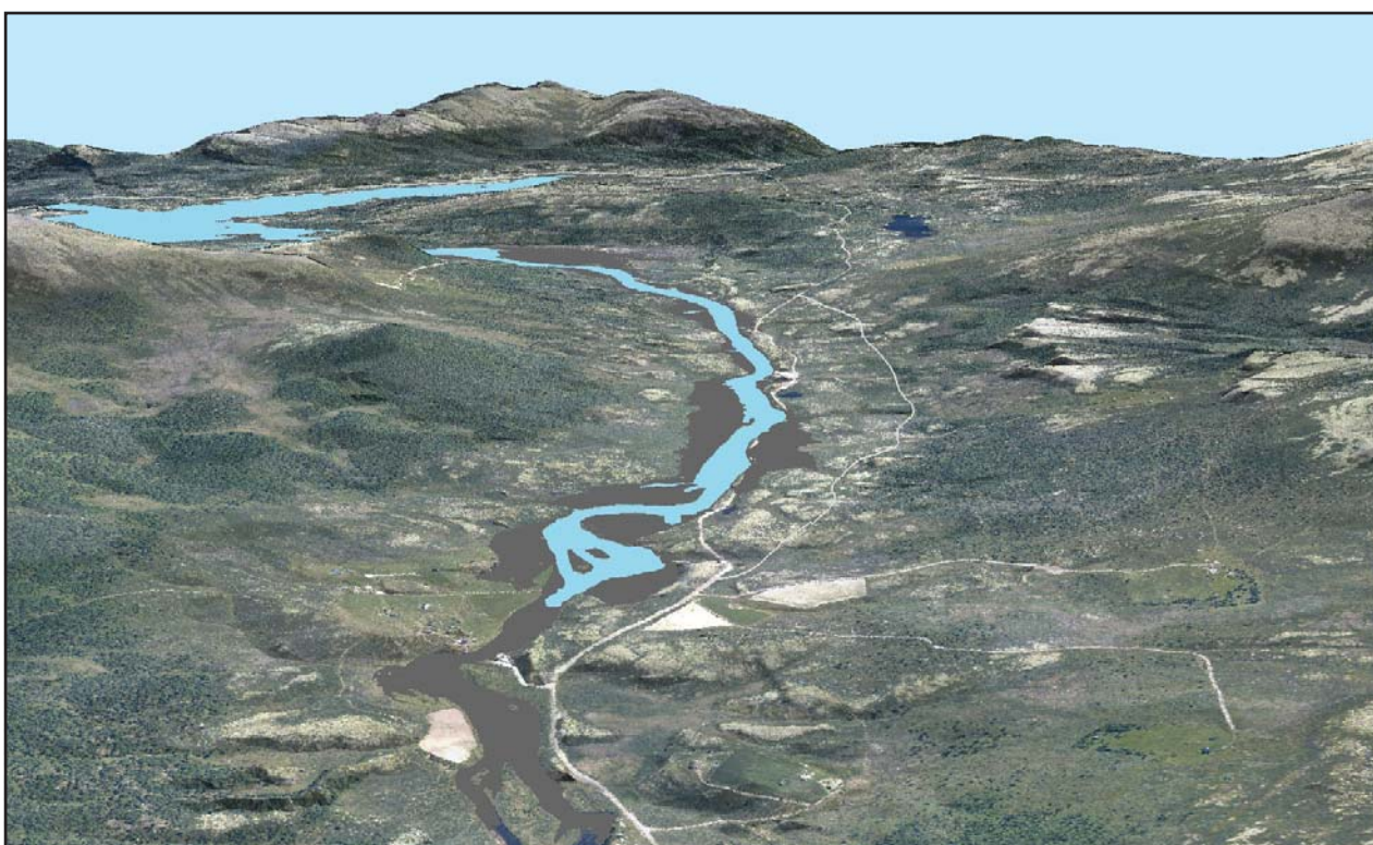
3D bilde fra Kjølhaug- og Randmelsætra ved HRV 870. Blå flate viser sommer LRV 868,50. Grått parti viser erosjonssone (uten avbøtende tiltak) mellom HRV og sommer LRV.
