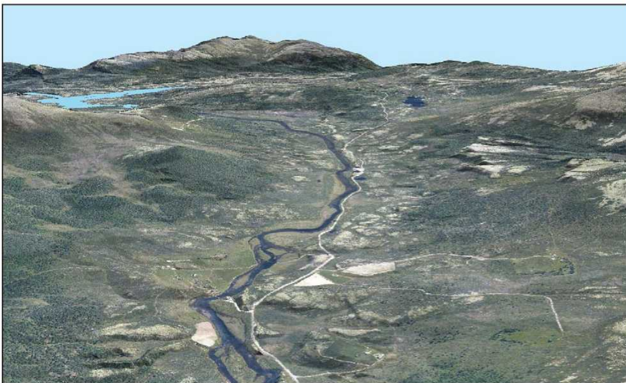
3D bilde fra Kjølhaug- og Randmelsætra ved HRV 863. Blå flate viser sommer LRV 861,50. Grått parti viser erosjonssone (uten avbøtende tiltak) mellom HRV og sommer LRV.
