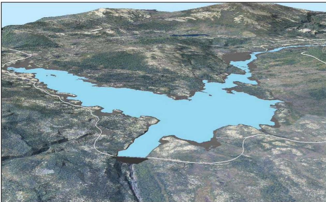
3D bilde fra ny dam ved HRV 870. Blå flate viser sommer LRV 868,50. Grått parti viser erosjonssone (uten avbøtende tiltak) mellom HRV og sommer LRV.
