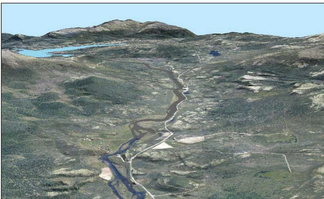
3D bilde fra Kjøllhaug- og Randmelsætra ved HRV 868. Blå flate viser sommer LRV 866,50. Grått parti viser erosjonssone (uten avbøtende tiltak) mellom HRV og sommer LRV.
