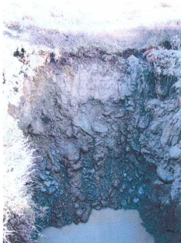
Sjakt, vannfylt ved ca. 3 m dyp
