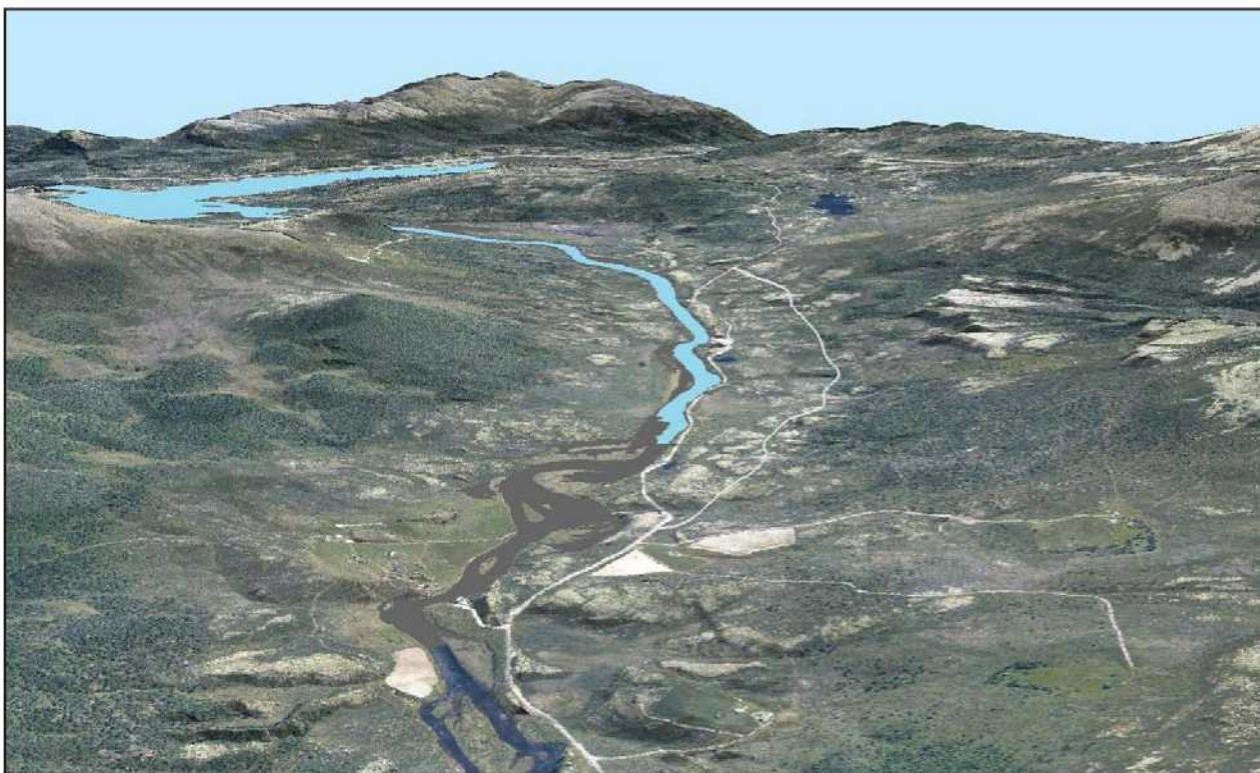
3D bilde fra Kjølhaug- og Randmelsætra ved HRV 869. Blå flate viser sommer LRV 867,50. Grått parti viser erosjonssone (uten avbøtende tiltak) mellom HRV og sommer LRV.
