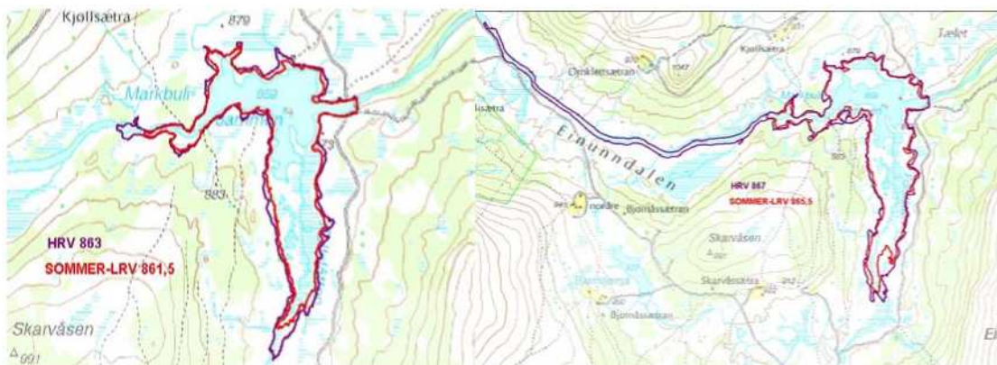
Figur 1. Kart over vannstand ved kote 863, med sommer LRV på 861,5 (venstre) og kote 867, med sommer LRV 865,5 (høyre).
