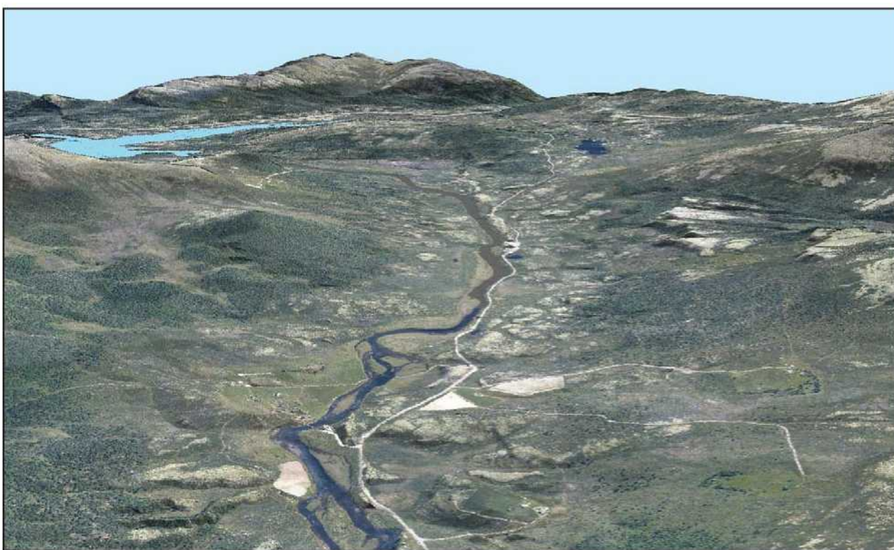
3D bilde fra Kjøllhaug- og Randmelsætra ved HRV 867. Blå flate viser sommer LRV 865,50. Grått parti viser erosjonssone (uten avbøtende tiltak) mellom HRV og sommer LRV.
