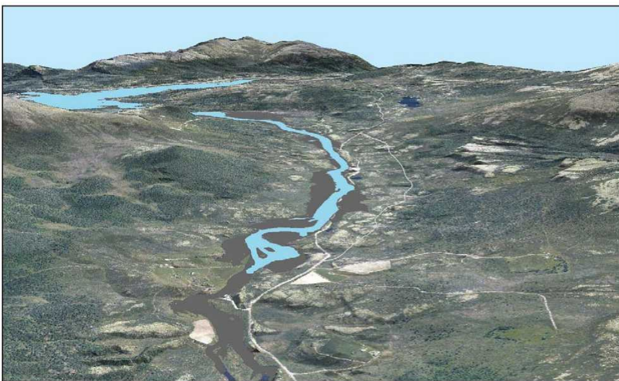
3D bilde fra Kjøllhaug- og Randmelsætra ved HRV 870. Blå flate viser sommer LRV 868,50. Grått parti viser erosjonssone (uten avbøtende tiltak) mellom HRV og sommer LRV.
