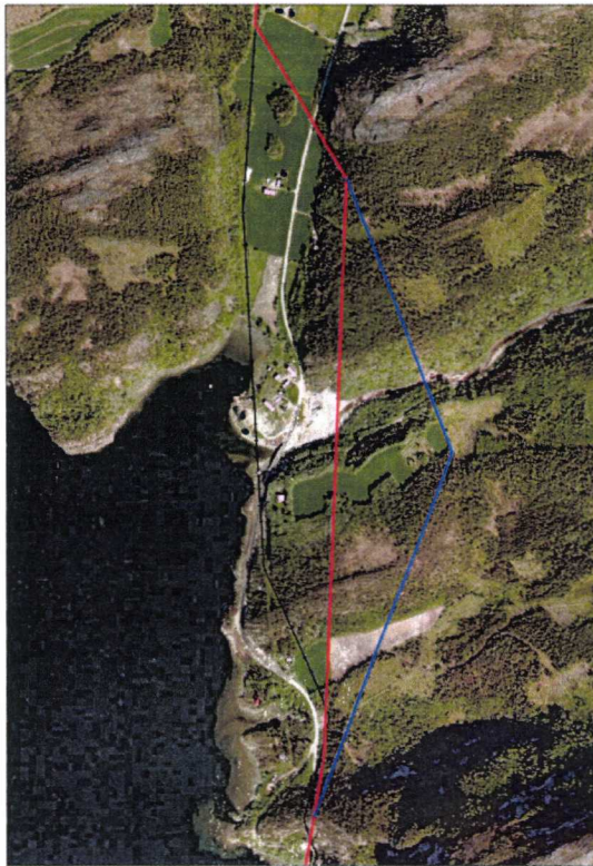
Figur 3: Flyfoto som viser konsesjonsgitt trasé for 132 kV (rød strek) og foreslått justert trasé (blå strek) ved Arnvika i Åfjord. Den svarte streken er eksisterende 66 kV kraftledning som skal rives ved bygging av den nye kraftledningen. Kilde: ASK notat 13.09.10.
