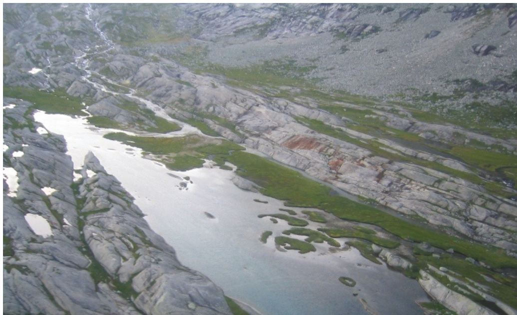
Bilde 3.4. Flyfoto av Vatn 400 med innløpselva. Fattigmyrvegetasjon ved utløpet og nordenden av vatnet. Den økte gjennomstrømmingen i vatnet som følge av overføringen av Sjuniogfemtivatn, har ført til økt erosjon og dannelse av "kanaler" i vegetasjonsdekket.
