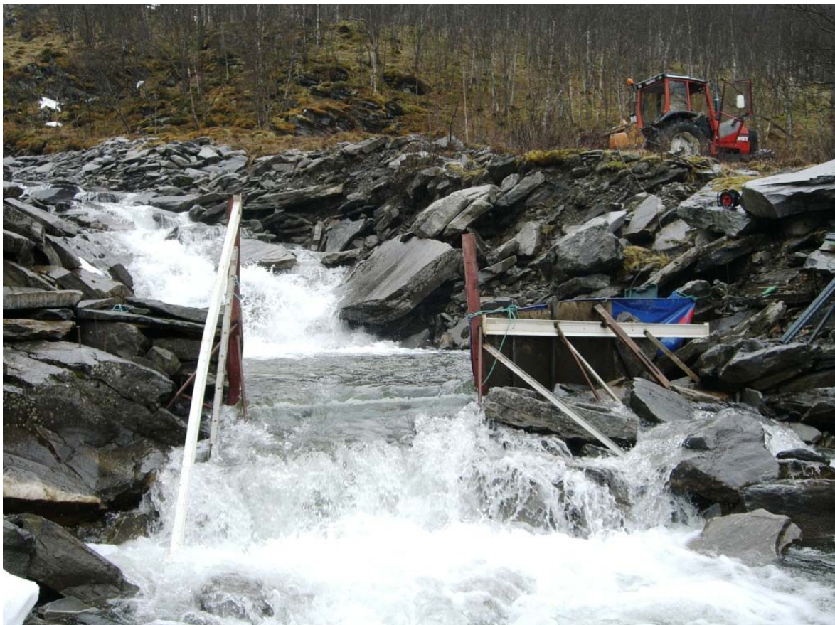
Bilde 6.2 Måledam for vannføringsmåling
