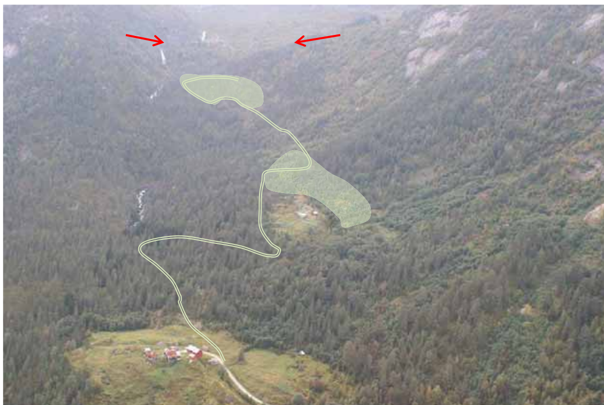
Figur 7.14. Sperleelvi nederst med Vassdøla og Liadøla (ikke synlig). Inntakspunkter, omtrentlig plassering av tipper (grønt) samt trasé for anleggsvei opp til tverrslag er indikert. Gårdshaug foran og Vårstølen bak.
