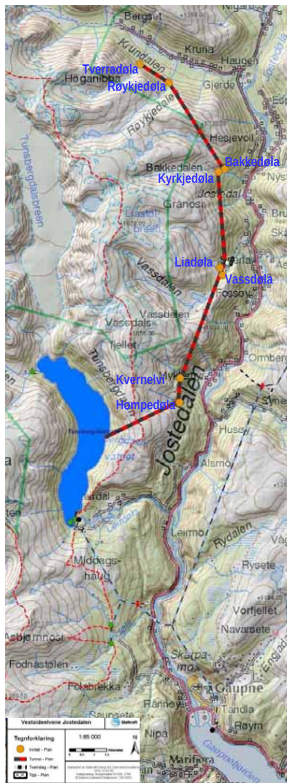
Figur 4.1. Tiltaksområdet – inntakspunktene er vist med gult og overføringstunnel med sort-rød linje.
