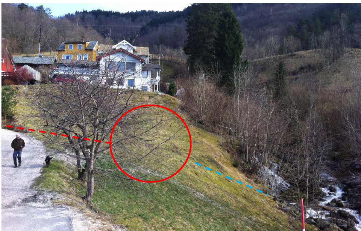
Figur 5 - 18: Nærbilete av mogeleg plassering av kraftstasjon er markert med runding. Trykkkrøyet er indikert med raud stipla line. Produksjonsvatnet vil verta ført i lukka grøft til elva skissert med blå line. Foto; Ole Reidar Flatby
