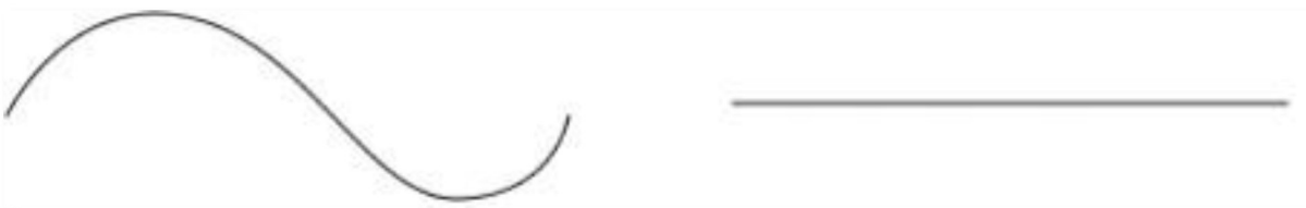
Figur 14. En veglinje er imidlertid et 3-dimensjonalt objekt og en linje på tvers av terrengets former vil fort få et langt mer krevende vertikalprofil. Dette kan medføre større skjæringer og fyllinger som er både tidkrevende og kostbart å bygge, samtidig som inngrepet vil bli langt mer dominerende i landskapsbildet. Vertikalprofilen til en linje som følger terrengets kurver vil gjerne bli en langt rettere linje i vertikalplanet.
