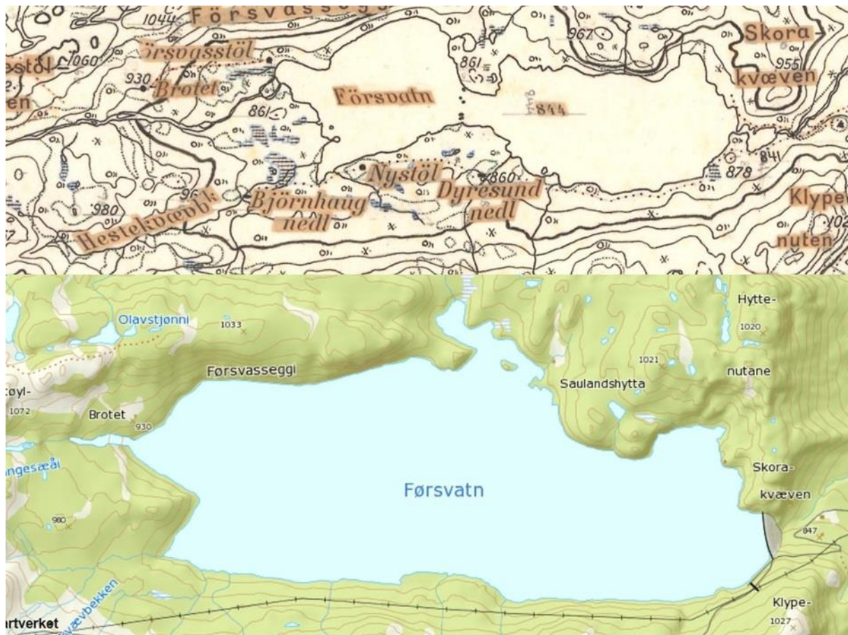
Figur 5.10. Førsvatn før og etter oppdemming. Grateigskart D35-1 fra 1956 er sammenstilt med kart hentet fra norgeskart.no. Regulering 891-829 moh.
