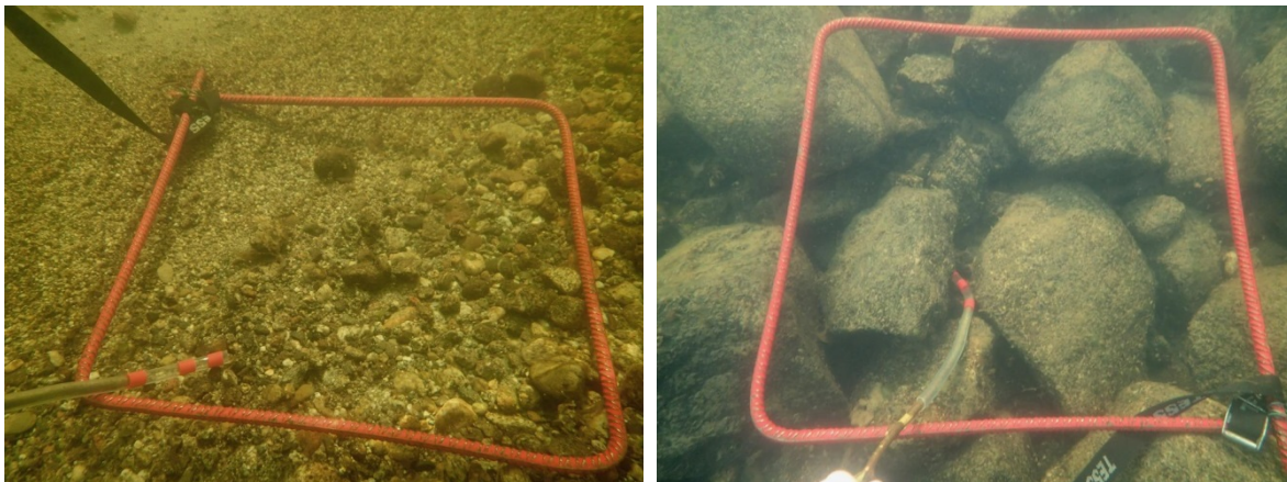
Figur 1: Skjulforhold for ungfisk måles ved å kvantifisere antall og størrelse på hulrom i elvebunnen med en plastslange (substrat-o-meter) innenfor en rute på 0,25 m 2 . Slangen er markert med røde markører som brukes til å måle størrelsen (dybde) av hulrommene. Eksempelbilder på skjulmålinger fra Ljungan (Sverige) i substrat med mye fin grus og sand hvor det ikke finnes hulrom, og dermed svært lite skjul (t.v.), og i substrat med stein/blokk som gir mye skjul (t.h.).
