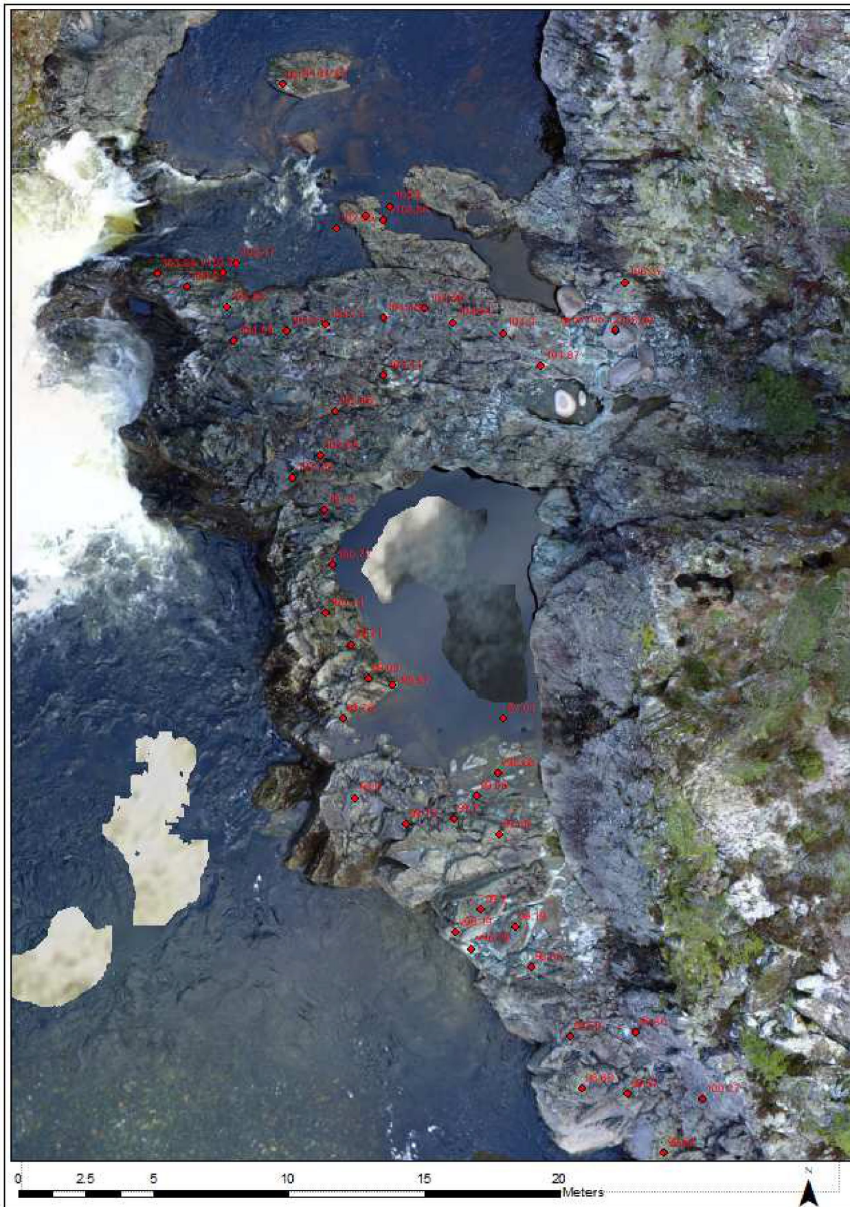
Figur 4: Oppmålingsdata fra 8.10.2017. Oppmålingene bekrefter at «ringen rundt jettegryten» som Tokke kommune ønsket vurdering om ligger på ca. kote 100 på foss-siden og på kote 99.7 på sørsiden.
