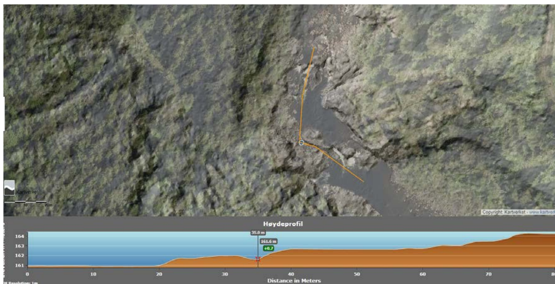
Figur 31. Høydeprofil vandringshinder 1 (kilde: kartverket). Trinnene er ca. 1 m høye. Det vanskeligste partiet (nedre foss) har en høyde på 2.6 m.
