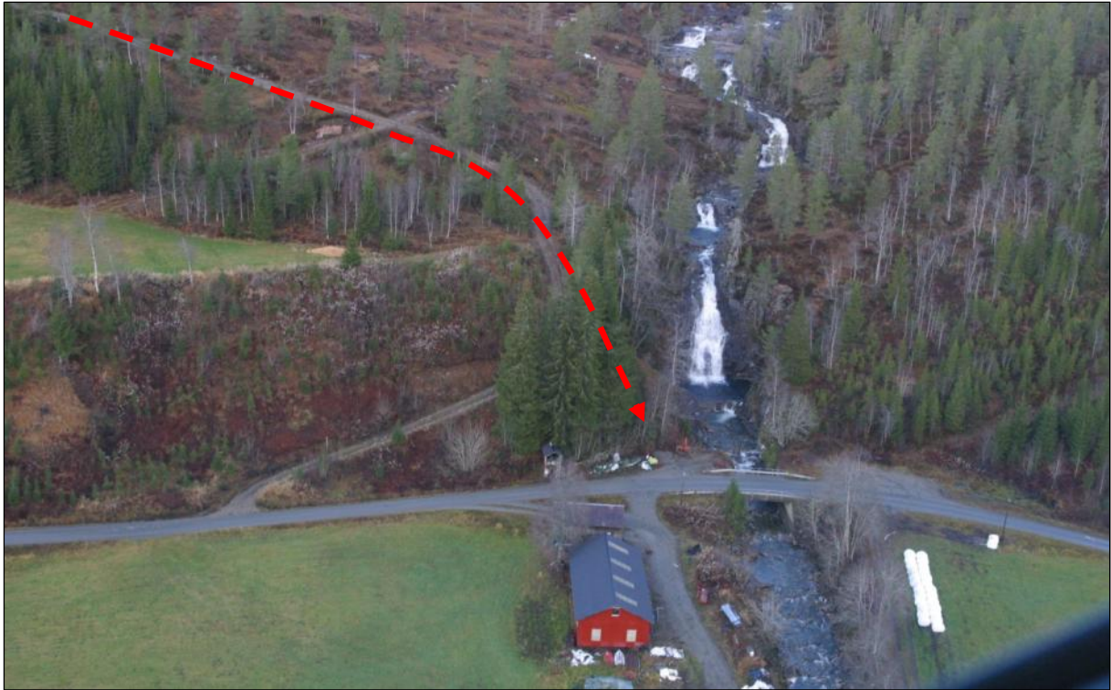
Bilde 2. Oversikt over nedre del av utbyggingsområdet med Toreseterfossen sentralt i bildet. Stiplet linje viser vannveien ned til kraftstasjonen som plasseres ovenfor veien på venstre side av elva.
