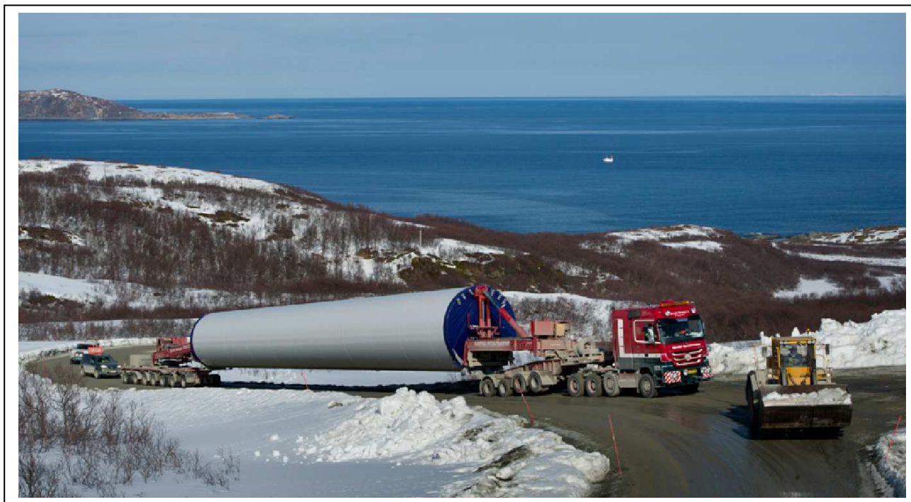
Figur 19: Det skal gode veger og sterke krefter til for å transportere turbinelementer inn i vindparken. Her et eksempel fra Fakken vindkraftverk 2012, med nedre tårnelement på veg til oppstillingsplassen. Stigningsgraden er ca. 12 %. (Foto: Troms Kraft Produksjon).
