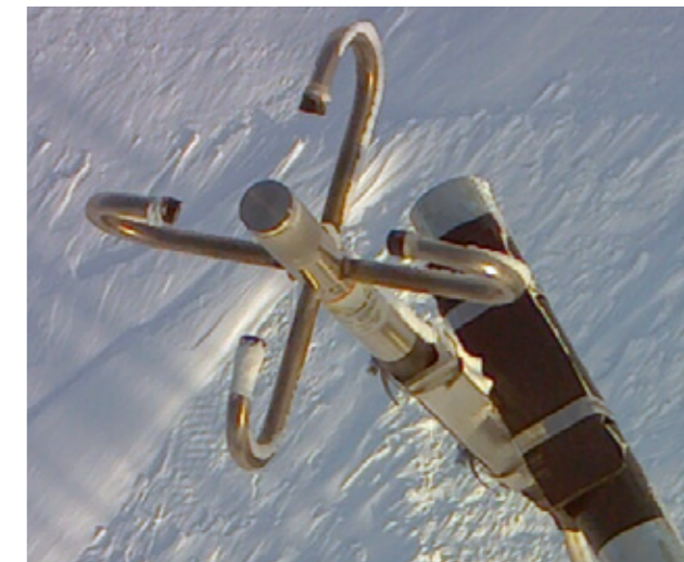
Fig.7.14: Lett ising på en av issensorene på Ånstadblåheia. Ising skjedde på natten og bilde er tatt neste morgen fra kamera som står sammen med sensorene.
