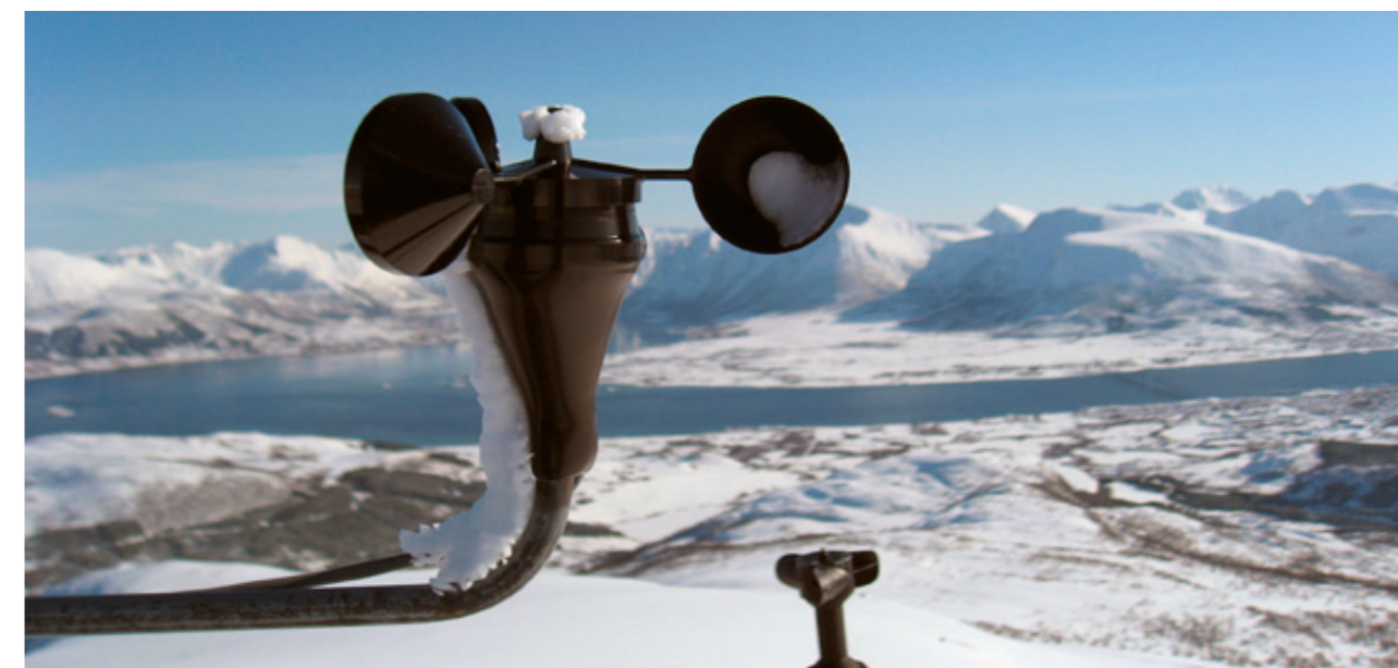
Fig.7.15: Vindmåler på Ånstadblåheia med noe ising på. Is resulterer vanligvis i lavere målt vindhastighet og stoppes når det kommer større mengder is på.
