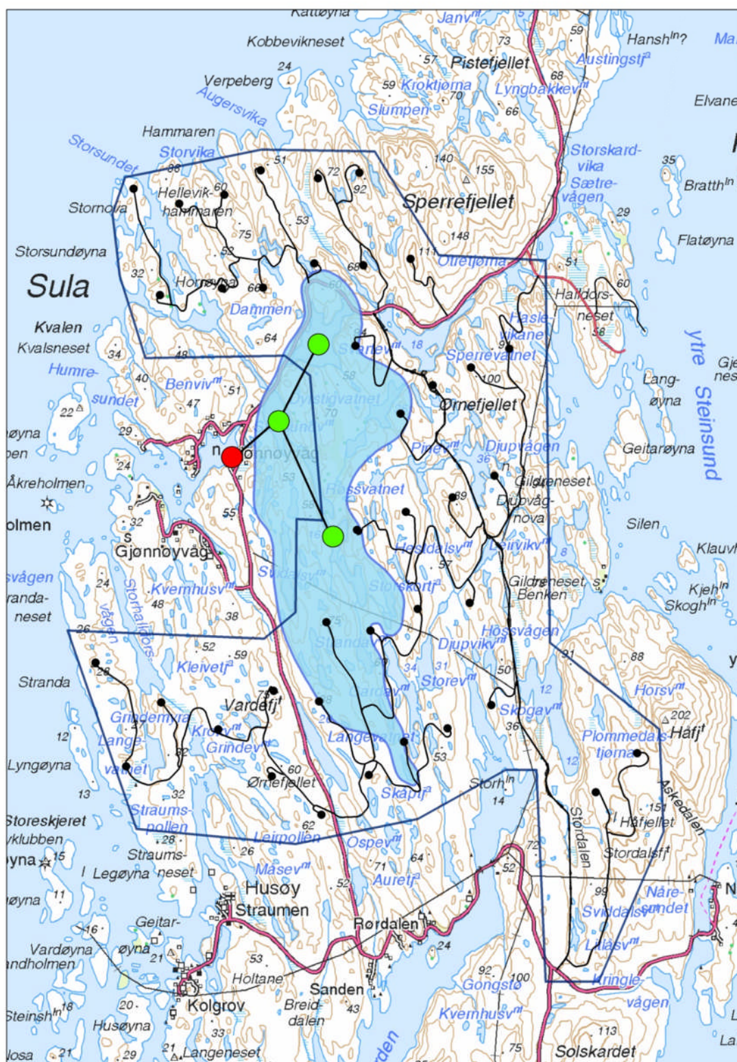
Figur 8-14 Nedbørfeltet til vatna der settefiskanlegget i Gjønnøyvåg hentar råvatn. Settefiskanlegget (raudt), inntak og overføringar (grønt), nedbørfelt angitt i blått.
