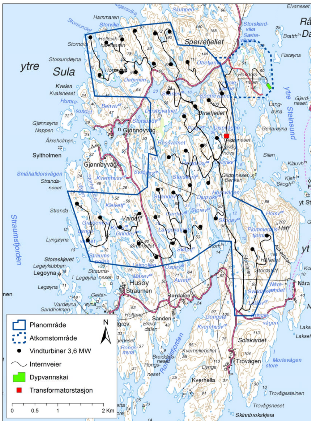
Figur 3-1 Utbyggingsløsning med 39 stk. 3.6 MW vindturbiner.
