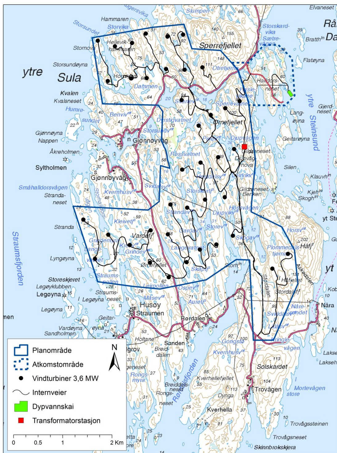
Figur 4 Utbyggingsløsning med 39 stk. 3.6 MW vindturbiner.
