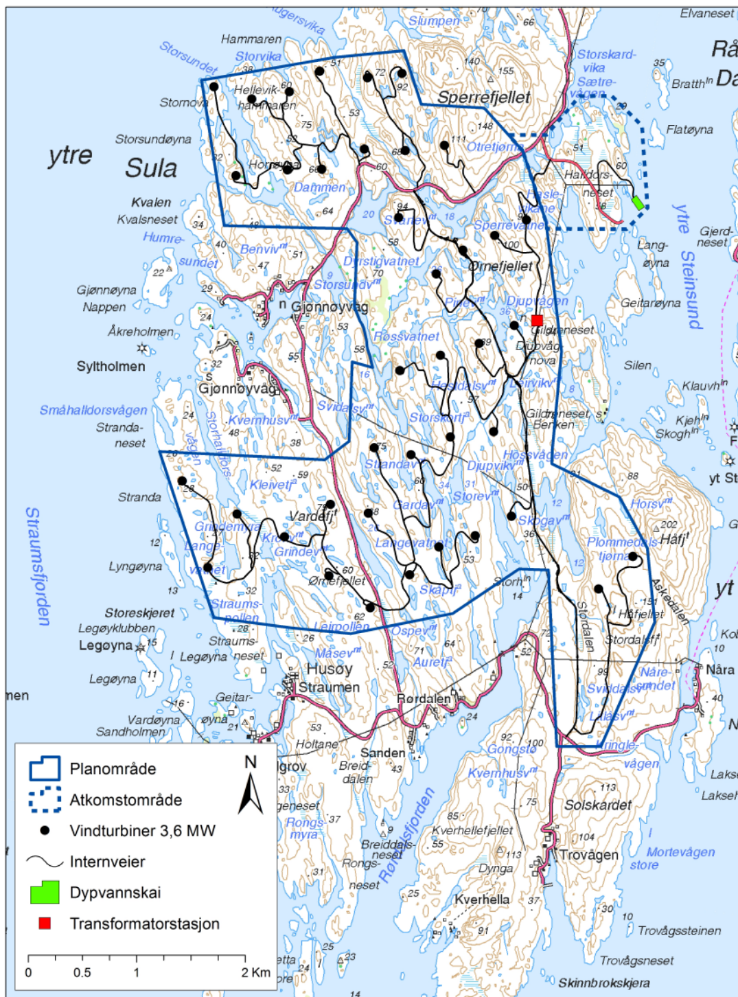
Figur 1 Utbyggingsløsning med 39 stk. 3.6 MW vindturbiner.
